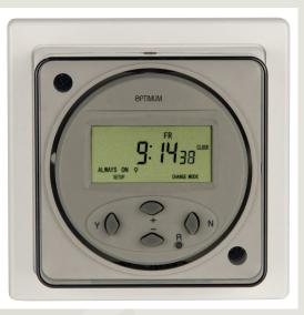
OP-SBDIGI IS A DIGITAL 24-HOUR / 7 DAY TIME SWITCH. MINIMUM SWITCHING TIME 1 MINUTE. THE TIMER IS SUITABLE FOR INSTALLATION ON A SURFACE OR IN-WALL PAT-TRESS BOX. THE TIMER CONTROLS A VOLT-FREE CHANGEOVER SWITCH, WITH A RESISTIVE RATING OF 16 AMPERES.
